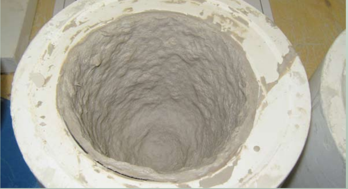
Yllä: Valu sellumassasta. Alla: Koe-esineen imeytys pellavaöljyvernissassa.
