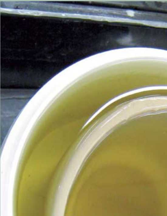
Yllä: Valu sellumassasta. Alla: Koe-esineen imeytys pellavaöljyvernissassa.
