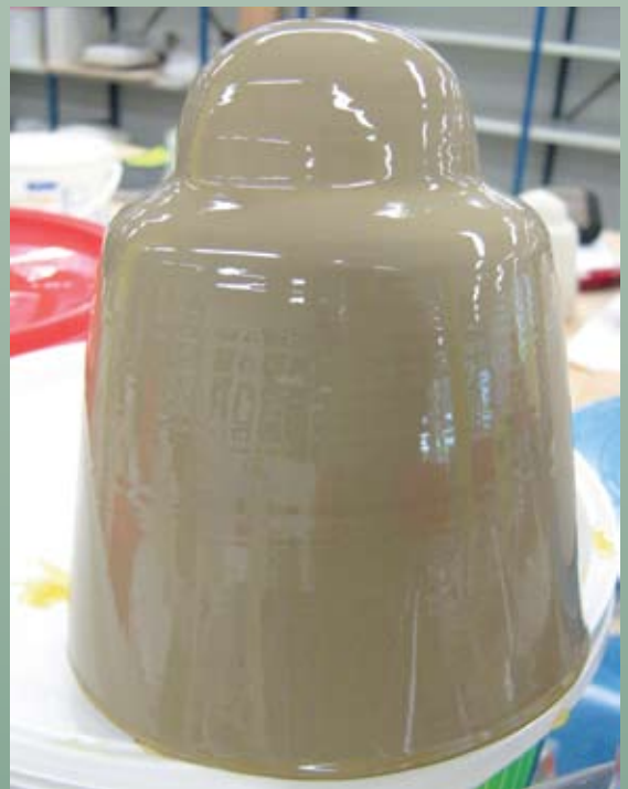
Yllä: Valu sellumassasta. Alla: Koe-esineen imeytys pellavaöljyvernissassa.
